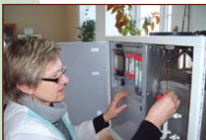
Augalų ir dirvožemio tyrimai – C, N, S nustatymas Diama metodu (Vario EL III, Elementar)
