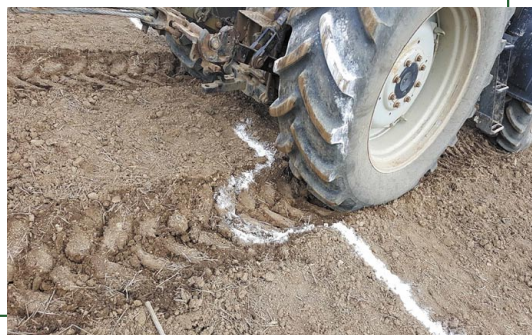
▲ Dirvožemio viršutinio sluoksnio pernešimas varančiųjų ratų buksavimo metu
