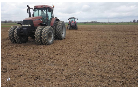
▲ Traktoriaus ratų poveikis dirvos paviršiui
