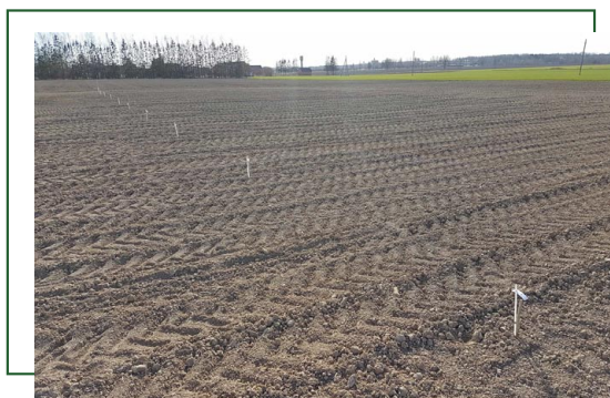
▲ Skirtingo kontakto ploto traktoriaus važiuoklių paveikti bandymo laukeliai
